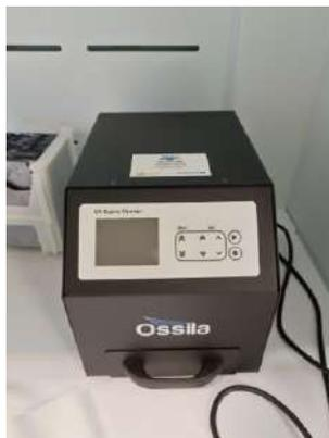
Figura 24: Imagen del sistema de limpieza por UV y O<sub>3</sub> (modelo L2002A3, fabricante OSSILA).
