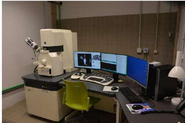
Figura 40: Imagen del Microscopio de barrido electrónico modelo EVO 15 de Zeiss (obtenida de la Web del SEGAI [64]).
