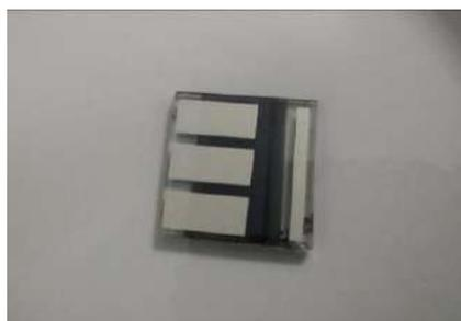
Figura 48: Célula Solar de Perovskita de 1ª Generación recién fabricada.
