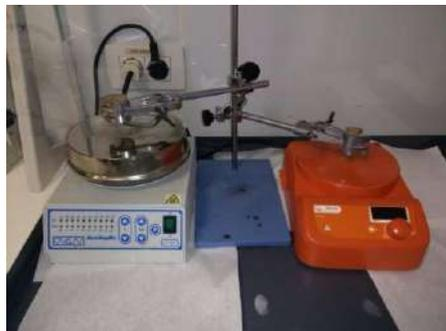
Figura 18: Imagen del Agitador magnético (derecha, modelo S03D 3L, fabricante Ibc Instruments) y del agitador magnético calefactado (izquierda, modelo BasicMagMix, fabricante O.V.A.N).
