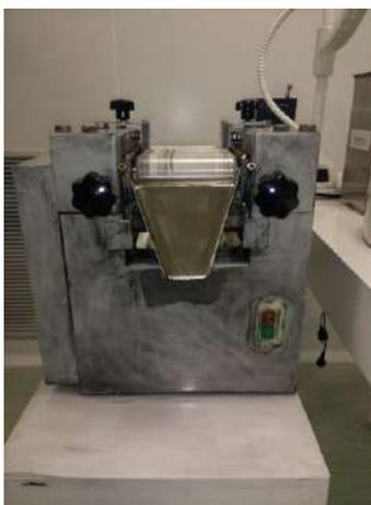
Figura 25: Imagen de la tricilíndrica (modelo ESSG65, fabricante Shanghai Espread).
