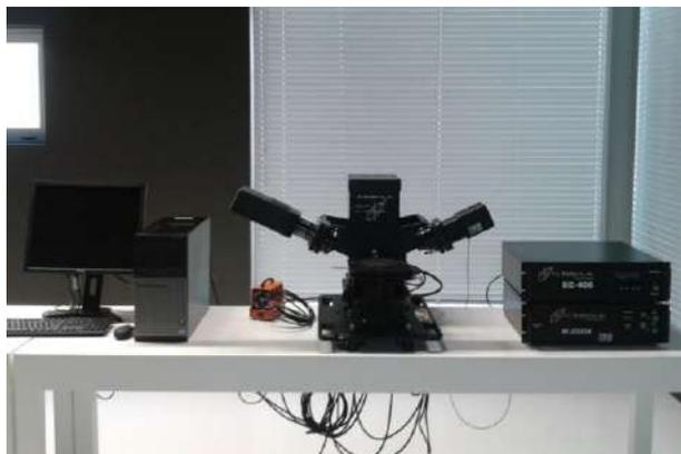
Figura 29: Imagen del Elipsómetro espectral (modelo ESM-300, fabricante J.A. Woollam).
