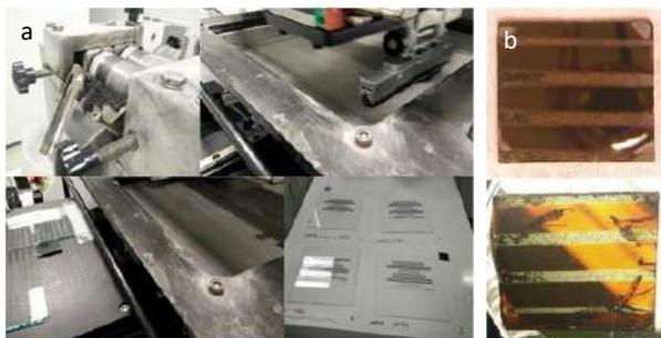
Figura 65: Imágenes tomadas durante la mezcla e impresión de la tinta, depositando contactos sobre sustratos de vidrio para medir su resistividad volumétrica (a) y sobre sustratos de vidrio recubiertos de perovskita para evaluar su efecto en la misma (b).
