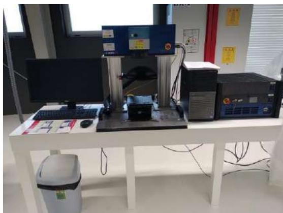
Figura 26: Imagen del láser pulsado (modelo LS-MarkIR, fabricante Lasing S.A).
