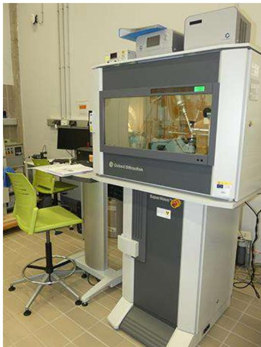
Figura 39: Imagen del Difractómetro de Rayos X modelo Rigaku Oxford Diffraction SuperNOV Ag (obtenida de la Web del SEGAI [63]).
