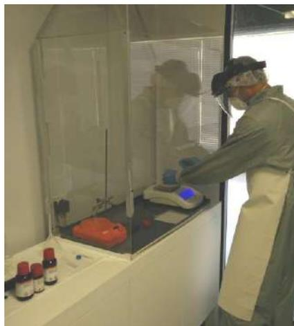
Figura 14: Imagen de la campana de gases (autofabricada por ITER).
