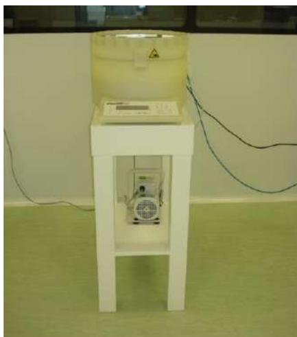
Figura 15: Imagen del centrifugador de obleas (modelo Polos HD 300, fabricante SPS).
