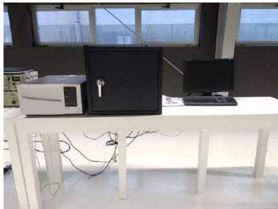
Figura 31: Imagen del Sistema de caracterización de semiconductores (modelo SCS-4200, fabricante Keithley).
