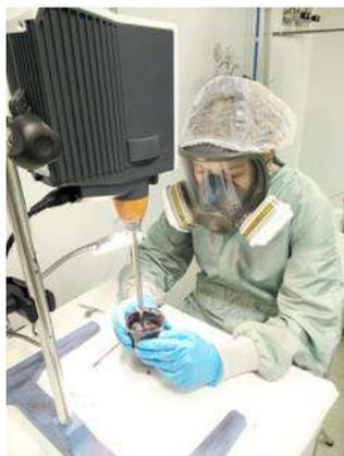
Figura 17: Imagen del agitador de varilla (modelo Hei-TORQUE Expert 400, fabricante Heidolph).
