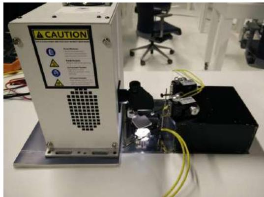
Figura 32: Imagen del Simulador solar (modelo 10500, fabricante ABET Technologies).
