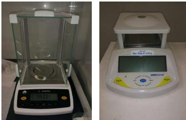
Figura 20: Imagen de la balanza de precisión (derecha, modelo PGL303, fabricante Adam Equipment) y de la balanza analítica (izquierda, modelo Entris 124i-1S, fabricante Sartorius).
