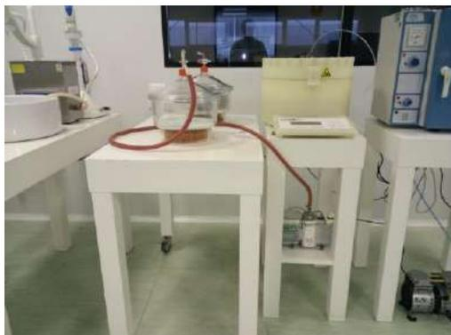
Figura 21: Imagen de dos campanas de vacío (modelo DE05-250-001, fabricante LBG).
