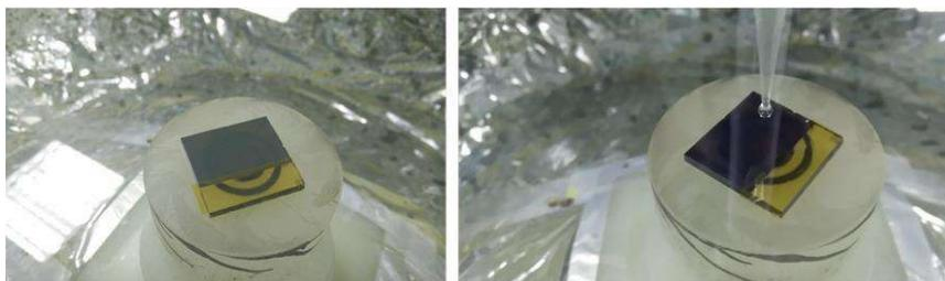
Figura 47: Imagen de un dispositivo en la cámara del centrifugador, con la capa de perovskita depositada (izquierda) y al que se le está pipeteando la disolución de HTM (derecha). En ambos casos hay una máscara de cinta de poliimida protegiendo el área donde no se quiere que se deposite HTM.
