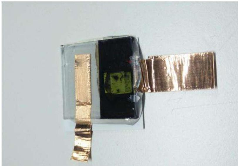
Figura 96: Imagen que muestra nuestro dispositivo después de pasar por un conjunto de medidas. Se puede ver un decoloramiento en la lámina de perovskita justo donde se encontraba la abertura en la máscara.
