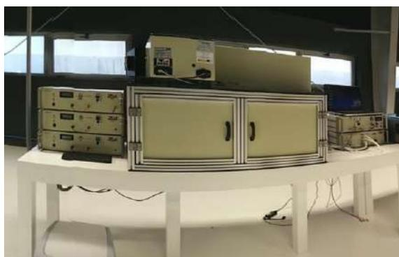
Figura 28: Imagen del Sistema de Respuesta Espectral (modelo PVE 300, fabricante Bentham).
