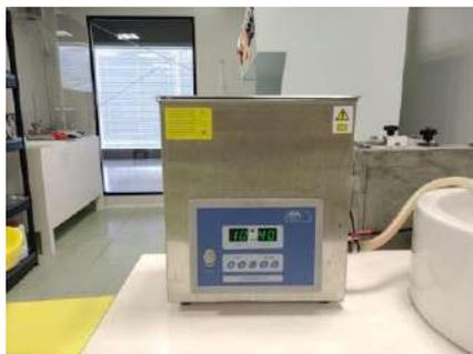
Figura 23: Imagen del baño de ultrasonidos (modelo ULTRASONS-HD 5L, fabricante JPSelecta).
